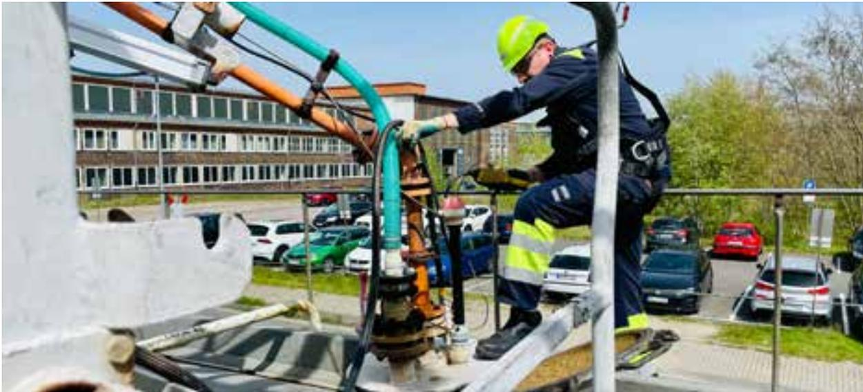
Bilder: Befüllen eines Straßentanklastzuges // Fotos: ICL-IP Bitterfeld GmbH
